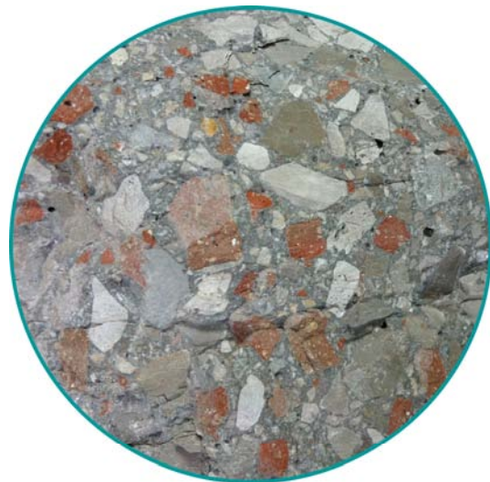
Fig. 239. Hormigón con incorporación de cerámicos procedentes de ladrillos.
