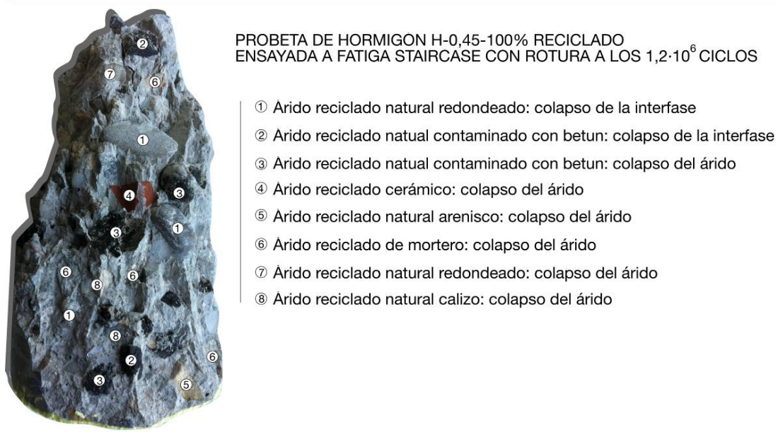
Fig. 233. Observación macroscópica de algunos detalles de interés en la fractura por fatiga de una probeta de hormigón reciclado.
