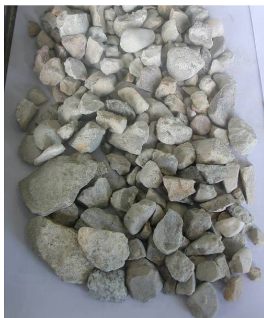
Fig. 120. Árido natural encontrado en el árido reciclado de la fase III.
