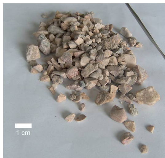
Fig. 113. Árido natural encontrado en el árido reciclado de las fases I y II.
