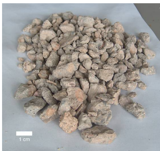
Fig. 112. Mortero y árido con mortero del árido reciclado de las fases I y II.
