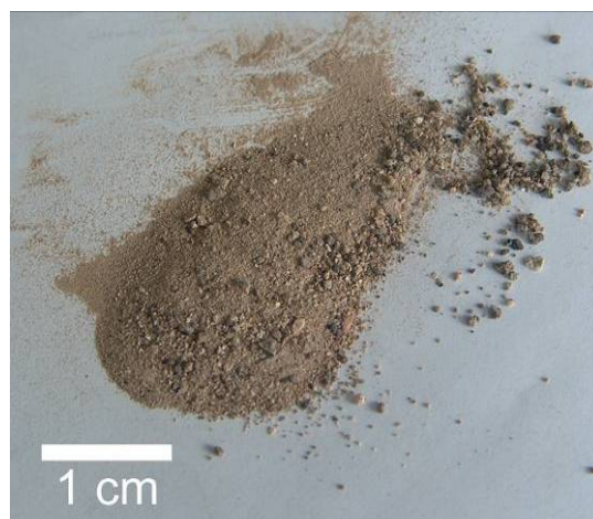
Fig. 117. Finos encontrados en el árido reciclado de las fases I y II.
