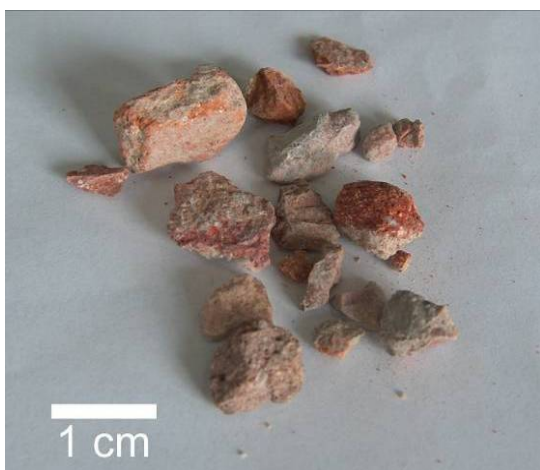
Fig. 116. Cerámicos encontrados en el árido reciclado de las fases I y II.
