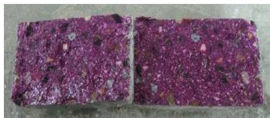
Fig. 138. Profundidad de carbonatación del H-0,50 100%.
