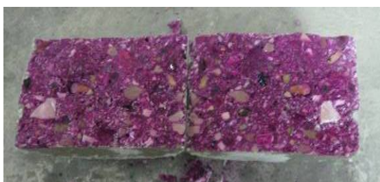
Fig. 135. Profundidad de carbonatación del H-0,65 50%.
