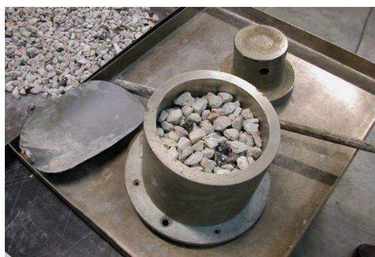
Fig. 125. Aspecto del árido mezcla y dispositivo antes de la realización del ensayo. Fases I y II, 50%, fracción 14/20.
