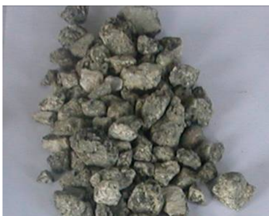
Fig. 121. Árido contaminado con betún de la fase III.
