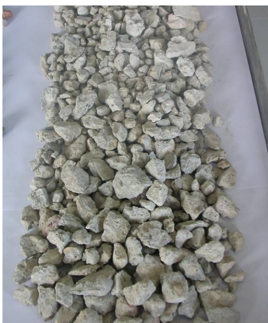
Fig. 119. Mortero y conglomerado encontrados en el árido de la fase III.
