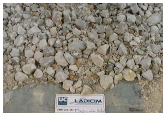
Fig. 126. Aspecto del árido tras la realización del ensayo. Fases I y II, 50%, fracción 14/20.
