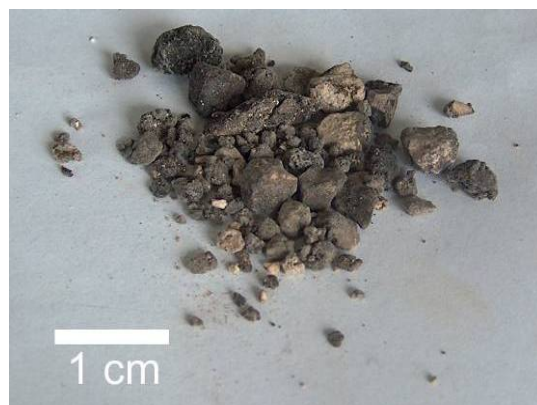
Fig. 115. Asfalto encontrado en el árido reciclado de las fases I y II.
