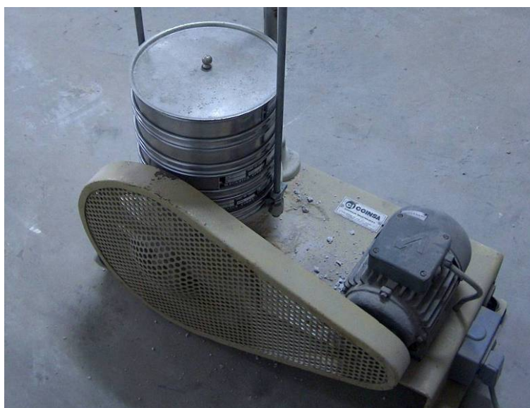
Fig. 24. Tamizadora de vaivén para análisis granulométricos.
