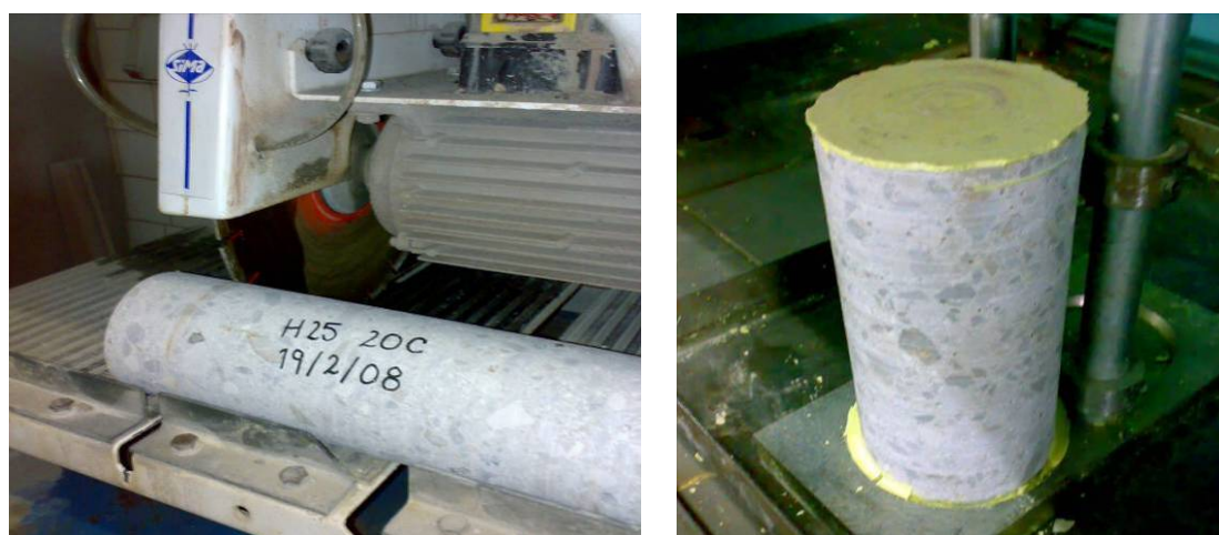
Fig. 102. Testigo durante el proceso de corte y refrentado con azufre.
