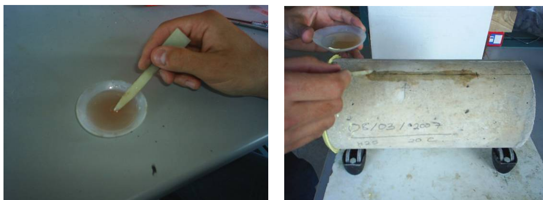
Fig. 94. Color que toma la mezcla cuando está lista para extenderse y aplicación del adhesivo sobre la probeta.
