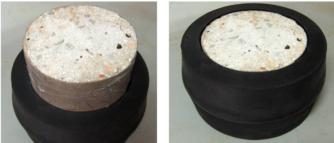
Fig. 79. Aspecto de la muestra parcialmente (izq.) y totalmente (dcha.) introducida en la junta de caucho.
