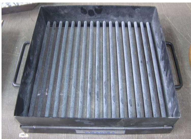
Fig. 25. Tamiz de barras para la determinación del índice de lajas.
