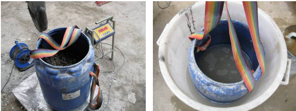
Fig. 47. Pesaje y saturación del árido grueso por inmersión en agua durante 10 min.
