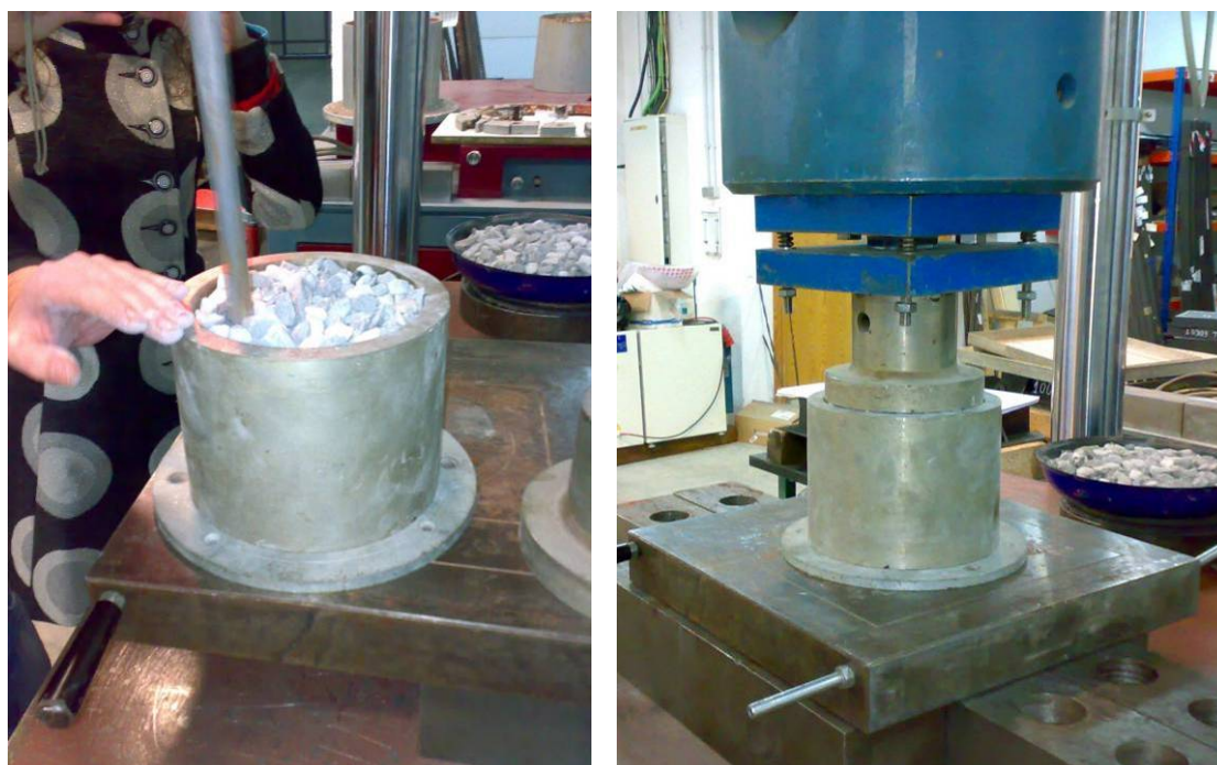
Fig. 38. Compactación del material en el molde cilíndrico (izq.) y aplicación de la carga de compresión en el transcurso del ensayo de determinación del índice de machacabilidad del árido (dcha.).
