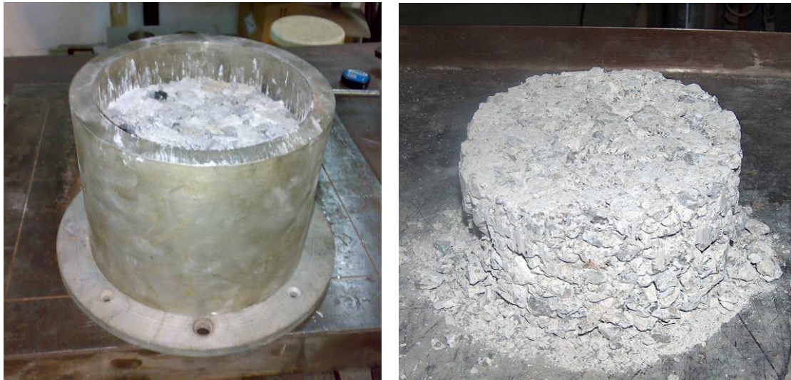
Fig. 39. Aspecto de la muestra del ensayo de machacabilidad tras retirar el émbolo (izq.) y después de su extracción del recipiente (dcha.).
