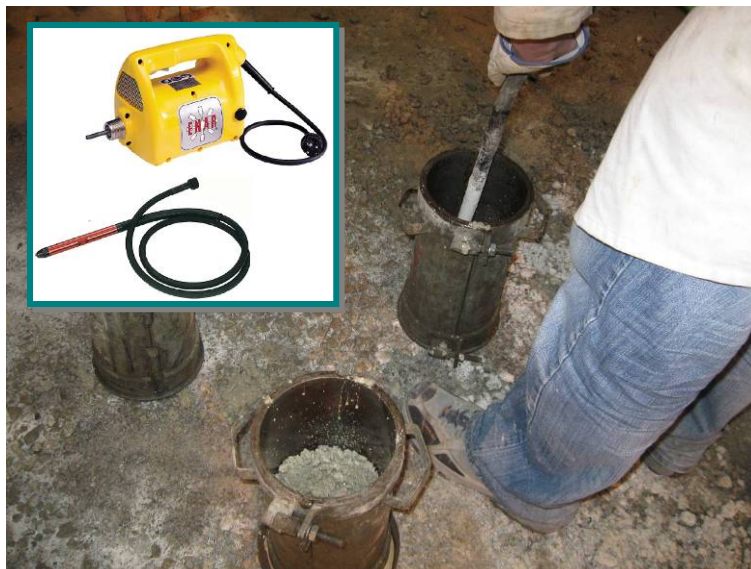
Fig. 54. Llenado y compactación, mediante aguja vibradora, de los moldes normalizados.
