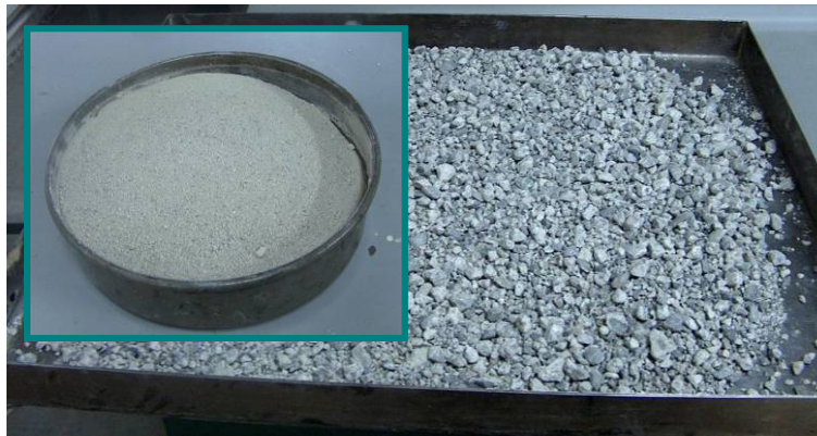
Fig. 36. Fracción pasante y retenida por el tamiz 1,60 mm tras la realización del ensayo de desgaste Los Ángeles.
