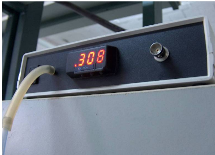
Fig. 84. Detalle del caudalímetro digital conectado y evaluando el flujo de oxígeno a la salida de la muestra.
