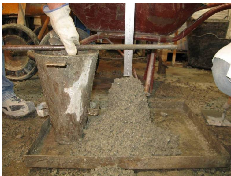
Fig. 51. Medida de la consistencia en el ensayo del asiento del cono de Abrams.
