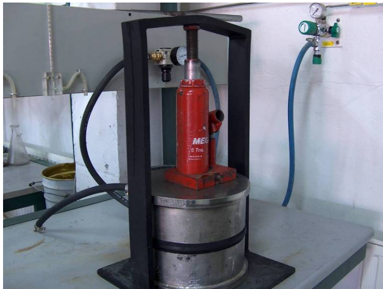
Fig. 82. Montaje final del dispositivo experimental, a falta de conectar la salida del portamuestras superior al caudalímetro de gases.
