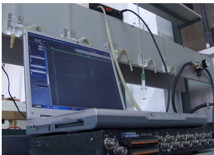
Fig. 83. Detalle del PC y tarjeta de adquisición de datos conectada al caudalímetro digital.
