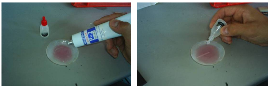
Fig. 93. Aplicación del primer componente del pegamento (90% de la mezcla) y adición del segundo componente del pegamento (10% de la mezcla).
