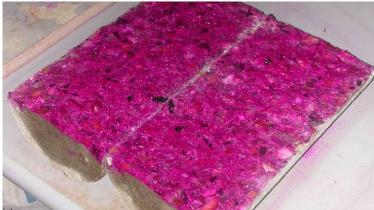
Fig. 76. Superficie interior de una probeta normalizada de hormigón, rota por tracción indirecta, a la que se ha aplicado una fina capa de fenolftaleína.
