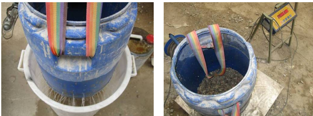
Fig. 48. Proceso de escurrido (izquierda) y posterior pesaje del árido grueso saturado (derecha).
