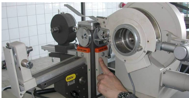
Fig. 19. Detalle del goniómetro utilizado por el difractómetro donde puede apreciarse el lugar donde se aloja el tubo de rayos X.
