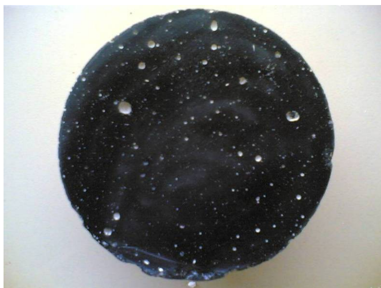
Fig. 58. Aspecto de la superficie de corte tras la aplicación del esmalte de fondo de color negro.
