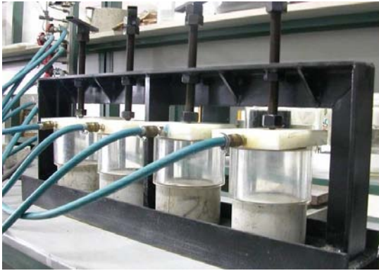
Fig. 85. Dispositivo experimental para los ensayos de penetración de agua bajo presión.
