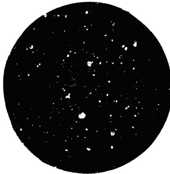
Fig. 73. Imagen B/N de una de las secciones de la probeta preparada para el análisis de la macroporosidad.
