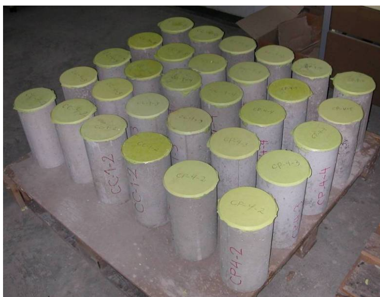
Fig. 88. Probetas normalizadas de hormigón refrentadas y preparadas para ensayar a compresión.
