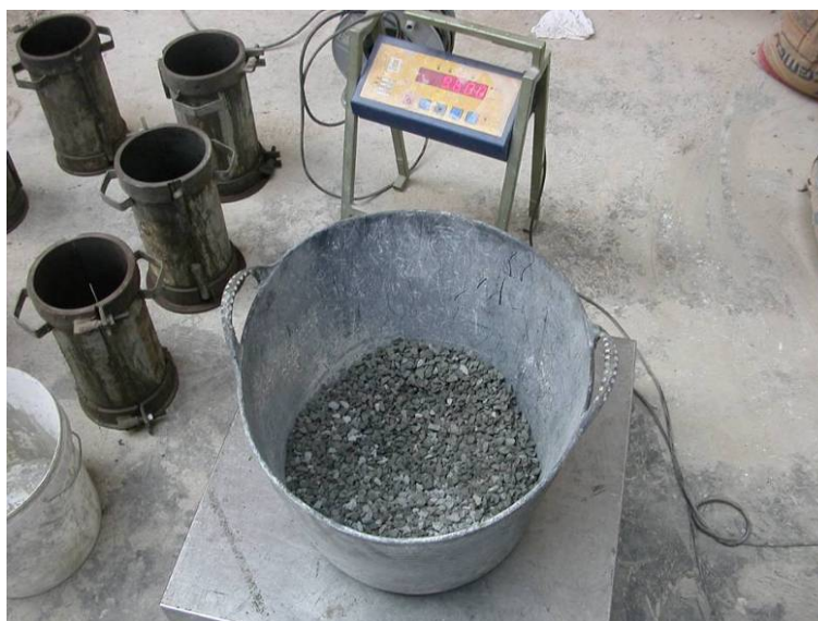
Fig. 43. Pesaje de la gravilla, utilizada en una de las amasadas, en una báscula de precisión.
