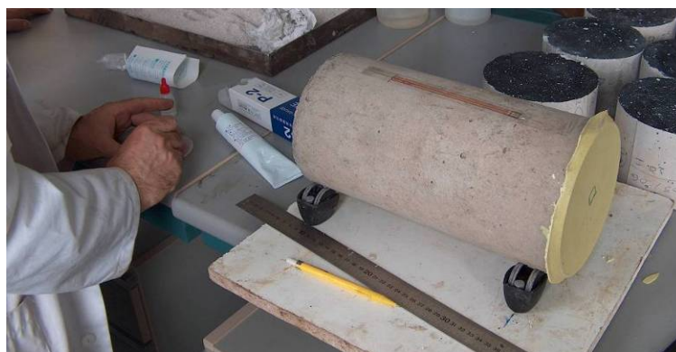
Fig. 92. Detalle del proceso de colocación de las galgas.
