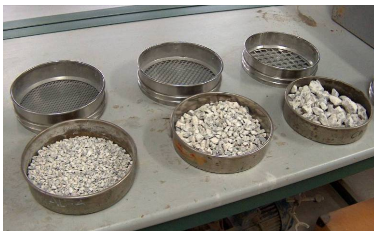
Fig. 26. Fracciones granulométricas para la determinación del coeficiente de forma del árido reciclado.
