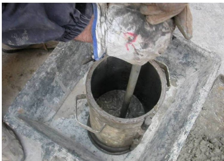
Fig. 52. Llenado y compactación, mediante picado, de los moldes normalizados.
