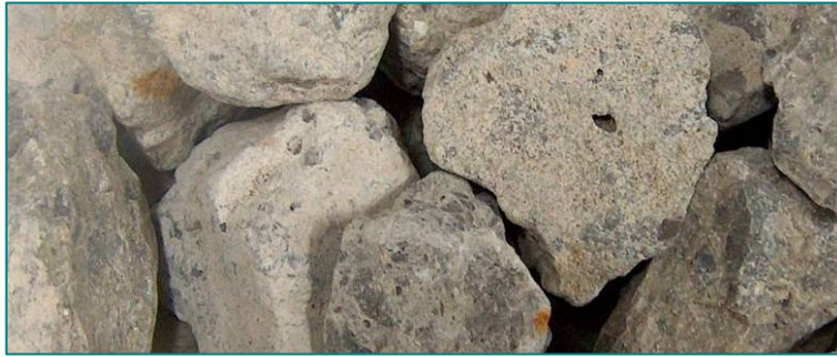
Fig. 27. Aspecto superficial del árido grueso reciclado en que se aprecian los restos de mortero adherido.
