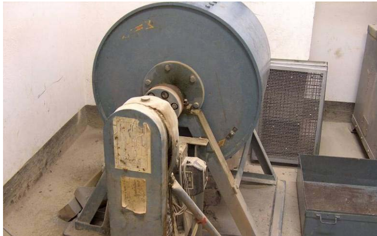
Fig. 35. Máquina de ensayo Los Ángeles para la determinación de la friabilidad.
