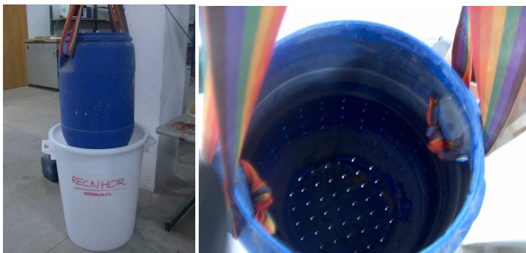
Fig. 45. Fotografía del dispositivo empleado (izda.) y detalle del interior (dcha.) del recipiente para la saturación de los áridos gruesos.
