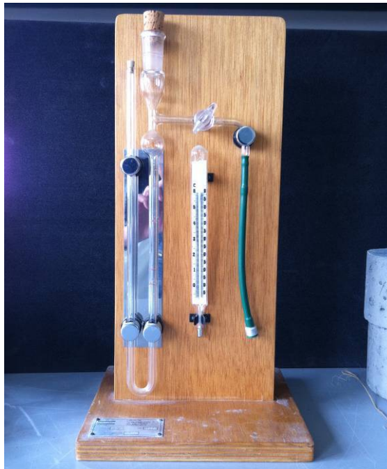
Fig. 17. Permeabilímetro Blaine para la determinación de la finura del cemento.
