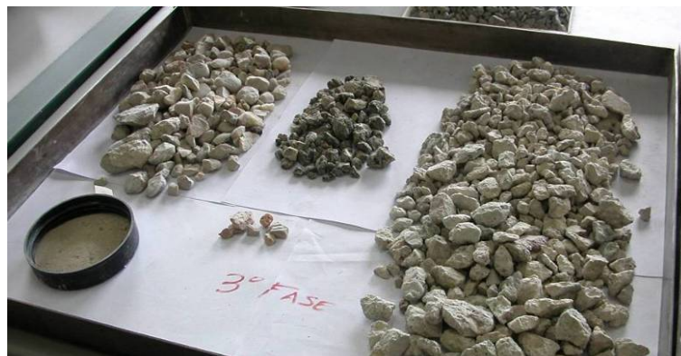
Fig. 21. Separación de componentes por inspección visual del árido reciclado procedente de hormigón.
