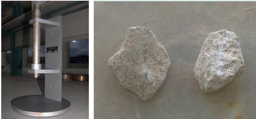
Fig. 34. Dispositivo provisto de sonda de cuzín (izq.) para la detección de partículas blandas en áridos gruesos (dcha.); se aprecia el surco producido por la sonda de cuzín.
