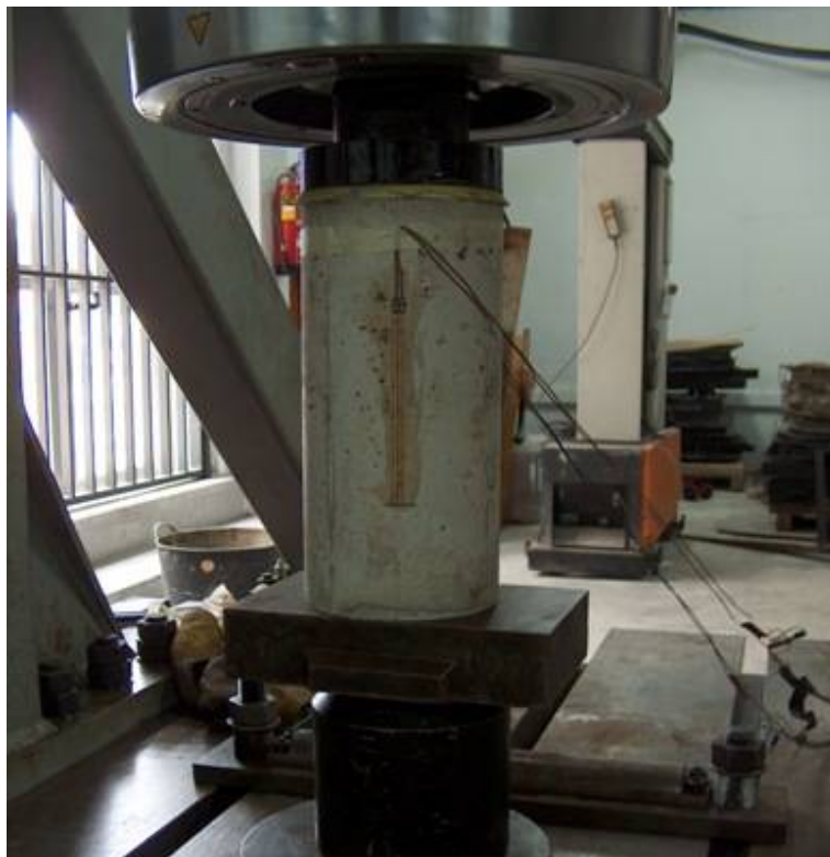
Fig. 96. Fotografía de la probeta instrumentada y colocada entre los platos de la prensa.
