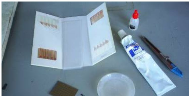
Fig. 91. Equipo necesario para la colocación de las galgas: galgas, conectores y adhesivo.
