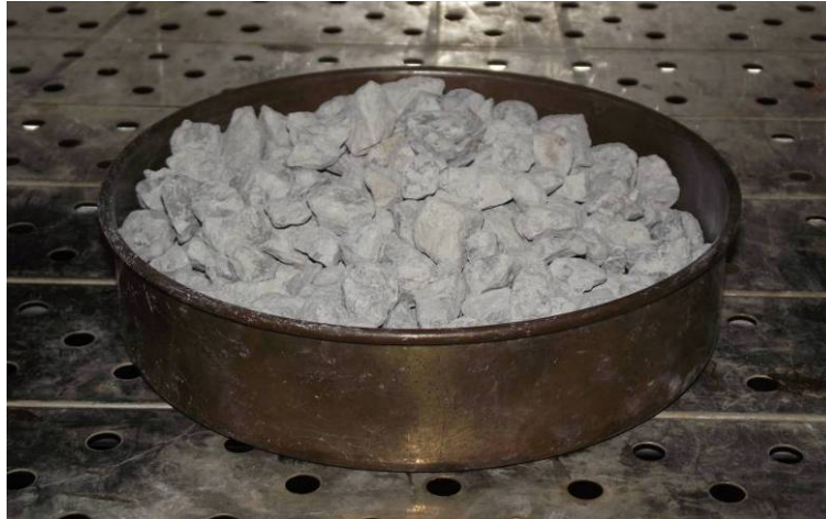
Fig. 23. Procedimiento de secado del árido en estufa a 110 \pm 5 °C.
