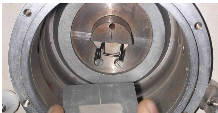
Fig. 20. Detalle de la muestra de cemento en el momento de su colocación.
