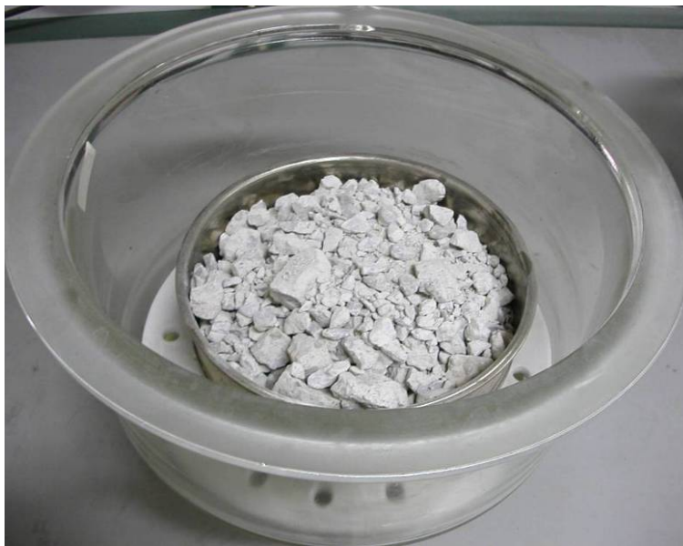
Fig. 33. Vasija utilizada como celda de vacío para la saturación del árido.
