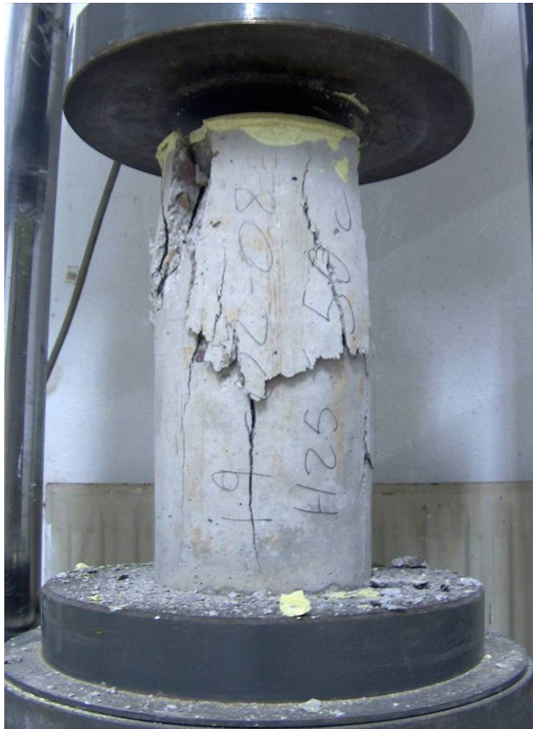
Fig. 89. Rotura a compresión simple de una probeta normalizada de hormigón.
