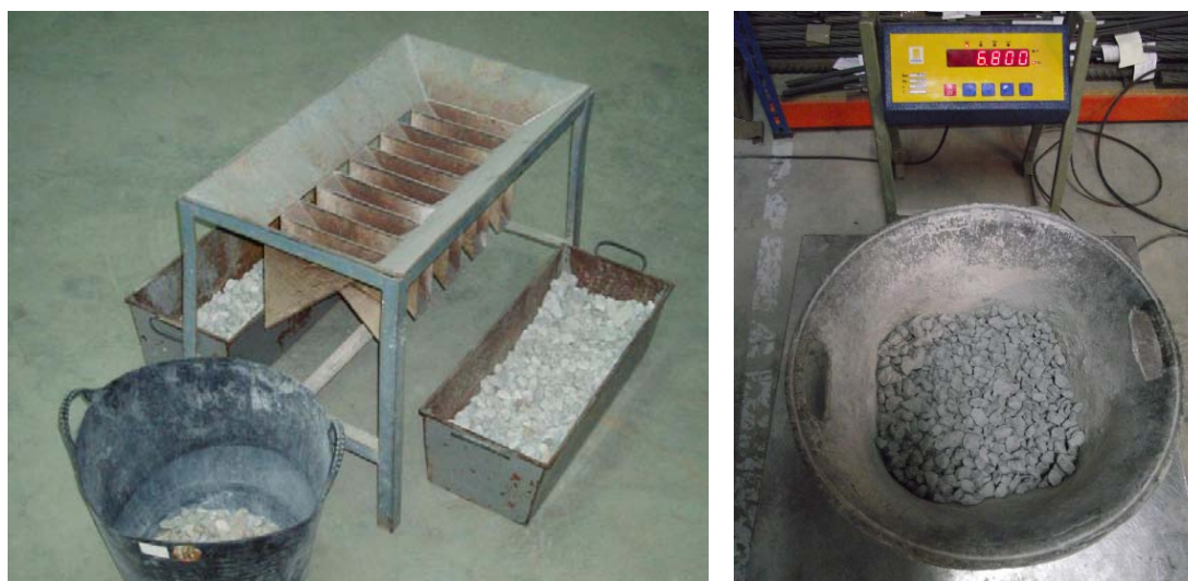
Fig. 22. Procedimiento de cuarteo del árido reciclado mediante rifles (izq.) y pesaje (dcha.).
