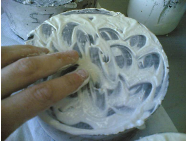
Fig. 59. Aspecto de la superficie de corte en el momento de la aplicación de la pasta de cemento blanca.
