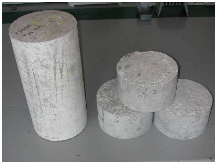
Fig. 57. Probeta normalizada (izq.) y aspecto de las muestras obtenidas a partir del despiece de probetas cilíndricas normalizadas de hormigón (dcha.).
