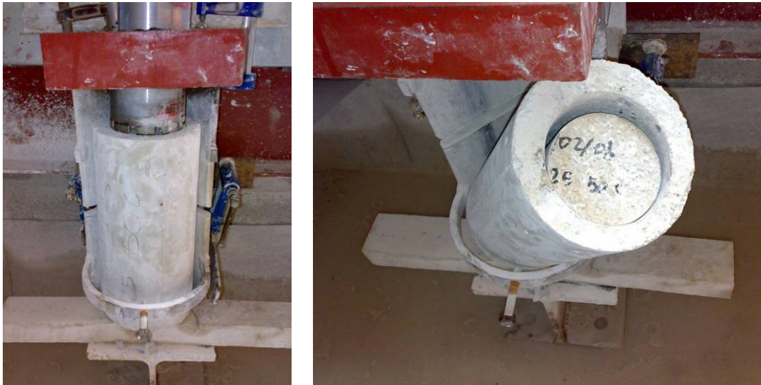
Fig. 100. Corona durante proceso de extracción (izq.) y extracción de la probeta del equipo portador, una vez realizada la operación de corte.
