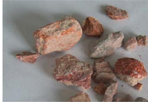
Fig. 7. Árido reciclado cerámico procedente de ladrillo.
