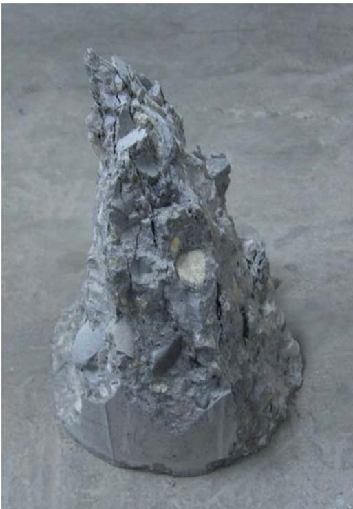
*Fig. 10. Rotura a compresión de una probeta cilíndrica normalizada de hormigón donde puede apreciarse cómo la rotura se ha propagado formando un cierto ángulo a través de la zona de menos resistencia: sollicitación a cortante.*
