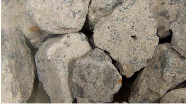
Fig. 6. Árido reciclado procedente de hormigón.
